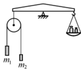
12. На нерастяжимой нити, перекинутой через невесомый блок, подвешены два груза массами  $m_1 = 100$  г и  $m_2 = 50$  г. В заторможенном состоянии (когда грузы неподвижны) блок уравновешен на рычажных весах. На какую величину  $\Delta m$  нужно изменить массу гирь на правой чашке, чтобы при освобождении блока (когда грузы придут в движение) сохранить равновесие весов?
