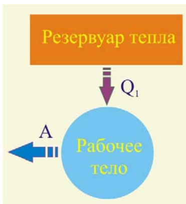
Рис. 117.2. Нереальная схема теплового процесса
