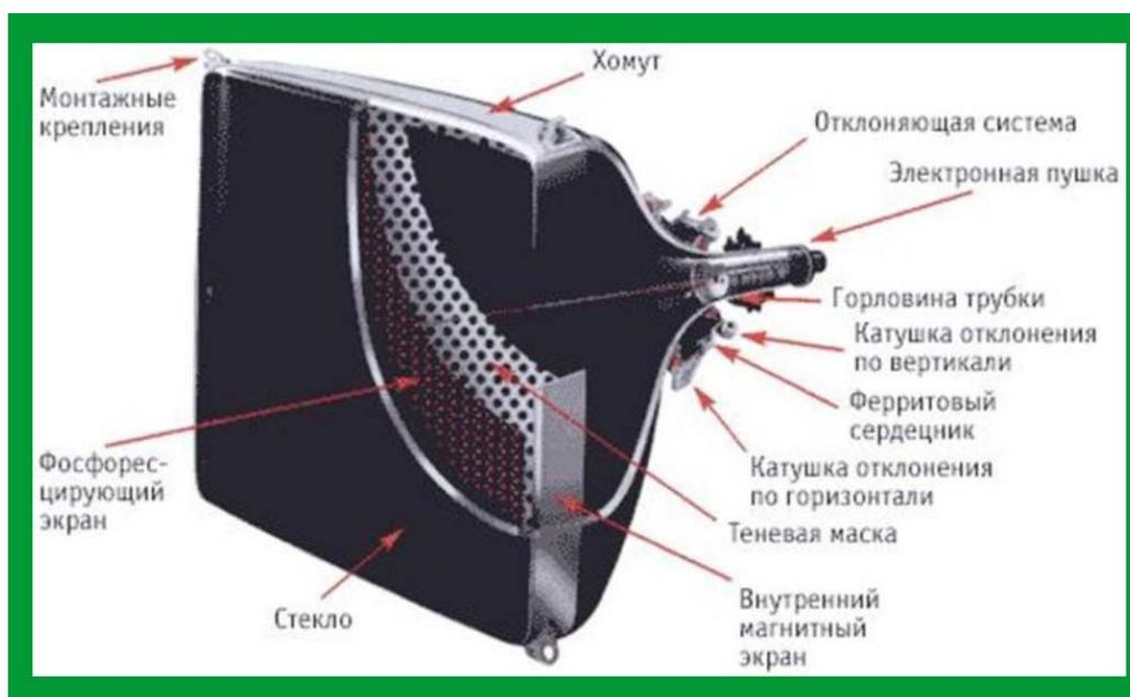
Рис. 24. Устройство кинескопа
