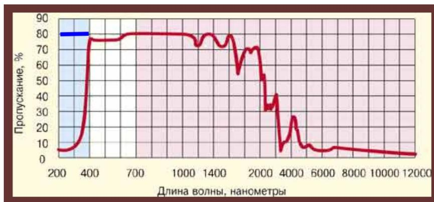
Рис. 20.1. Спектр пропускания обычного стекла
