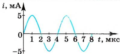
1. На рисунке приведён график зависимости силы тока от времени в колебательном контуре. Сколько раз энергия катушки достигает максимального значения в течение первых 6 мкс после начала отсчёта?
