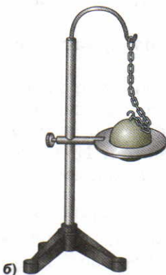
Рис. 18. Тепловое расширение металлического шара
