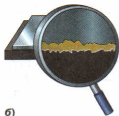
Рис. 82. Уменьшение силы трения с помощью смазки
