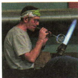
Рис. 29. Выдувание вазы из жидкого стекла
