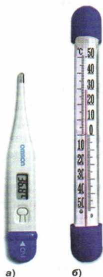
Рис. 11. Термометры: а — электронный; б — спиртовой
