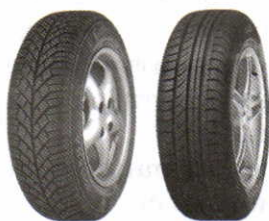
Рис. 86. Ребристые выступы на шинах позволяют увеличить трение
