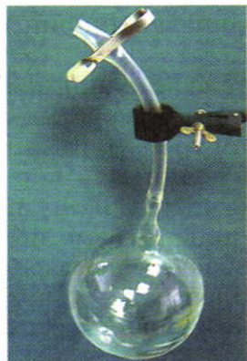
Рис. 124. Шар для взвешивания воздуха
