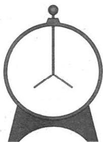
Опыт 3. Палочку вновь поднесли, не дотрагиваясь, к заряженному палочкой электроскопу
