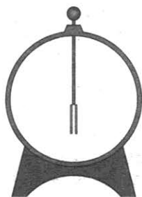
Опыт 1. Палочку и ткань в исходном состоянии поднесли поочередно к электроскопу
