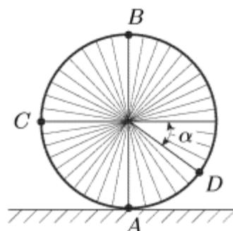
При качении колеса по земле все его точки участвуют одновременно в двух движениях: вдоль земли с постоянной скоростью  $v$ , направление которой все время горизонтально, и вокруг оси с линейной скоростью  $v_{\text{л}}$ . Скорость каждой точки определится как векторная сумма поступательной скорости колеса  $v$  и вектора линейной скорости в данной точке
