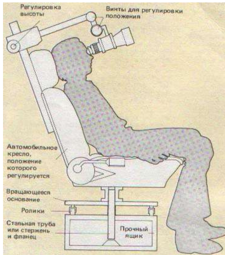
Рис. 30. Изготовить удобное кресло для наблюдений в бинокль — дело довольно простое. Крепление бинокля должно быть жестким, но допускающим плавную регулировку.
