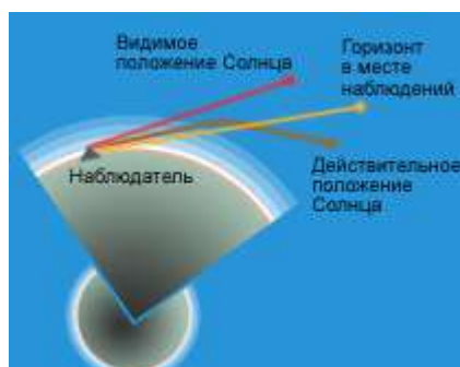
Рис. 4. Искривление луча света, вызванное рефракцией в атмосфере, как бы приподнимает все астрономические объекты над горизонтом. Солнце и Луна кажутся сплюснутыми у горизонта также вследствие рефракции.
