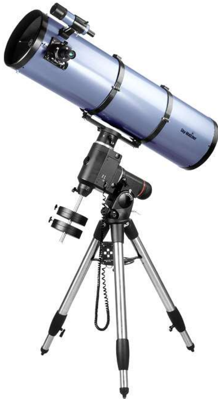
Рис. 39. Немецкая установка — наиболее распространенный способ монтировки телескопов; особенно удобен для небольших рефлекторов (типа показанного здесь), рефракторов и катадиоптрических телескопов.
