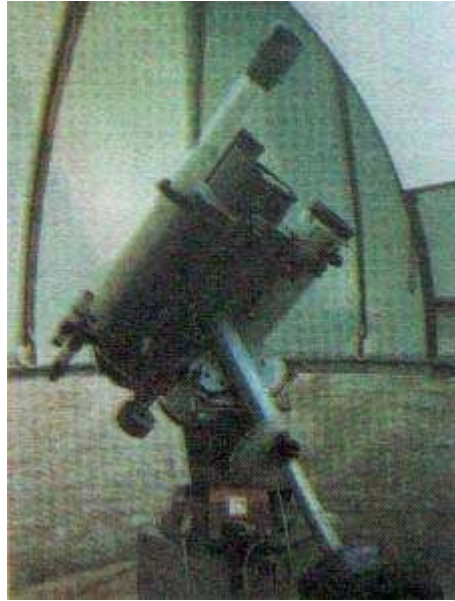
Рис. 38. Экваториальная установка, на которой укреплены две фотокамеры с апертурами 230 мм (9 дюймов) и 150 мм (6 дюймов) [фокальные отношения соответственно f/4 и f/6,3 ] вместе с гидрирующими 75-миллиметровым (3 дюйма) рефрактором и 150-миллиметровым рефлексом.
