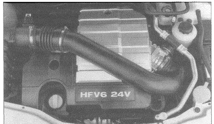
Моторный отсек Chevrolet Captiva, оснащённого шестицилиндровым V-образным двигателем мощностью 225 л.с.
