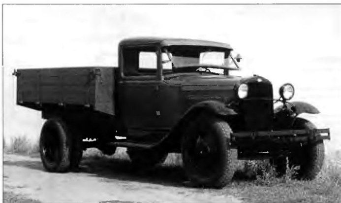
Полутонный грузовой автомобиль ГАЗ-АА с металлической кабиной
