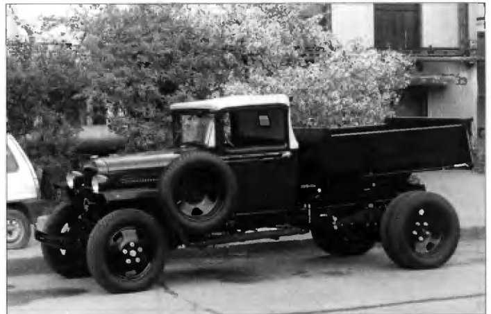
Грузовик-самосвал ГАЗ-410 на базе ГАЗ-АА (ГАЗ-ММ) ◆
