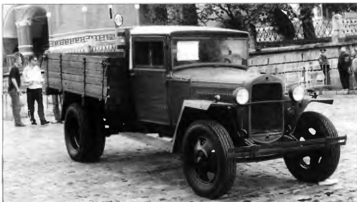
ГАЗ-ММ военного времени с деревянной кабиной
