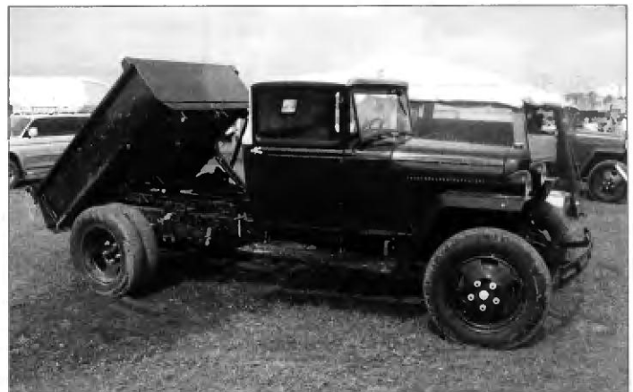
Грузовик-самосвал ГАЗ-410 на базе ГАЗ-АА (ГАЗ-ММ) ◆
