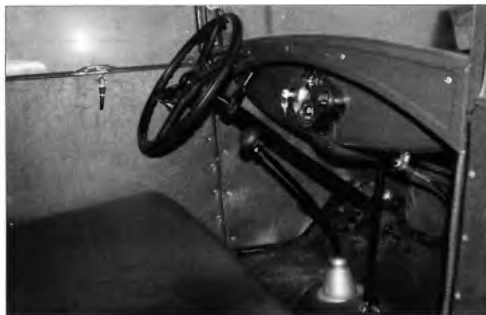
ГАЗ-АА: рабочее место водителя
