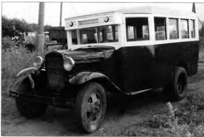
Автобус ГАЗ-03-30, выпускавшийся на базе грузовых автомобилей ГАЗ-АА и ГАЗ-ММ
