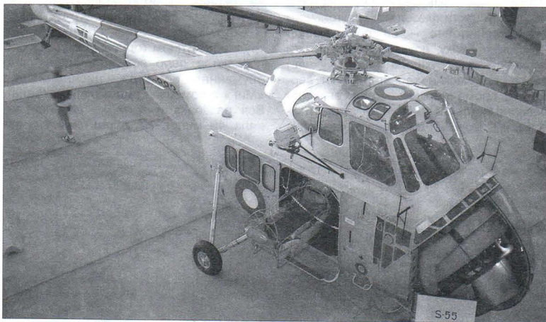
Вертолёт Сикорского S-55 имел необычную компоновку – его двигатель расположили спереди, освободив место для грузовой кабины под редуктором. На фото – британская модификация вертолёта WS-55 «Уирлвинд»
