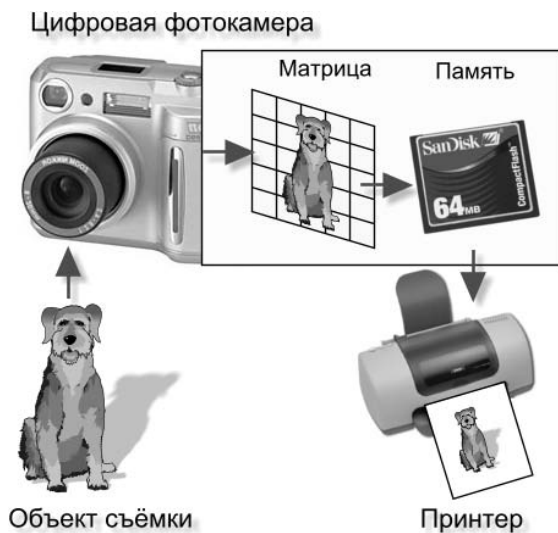
Рис. 10.14. Схема получения цифровой фотографии
