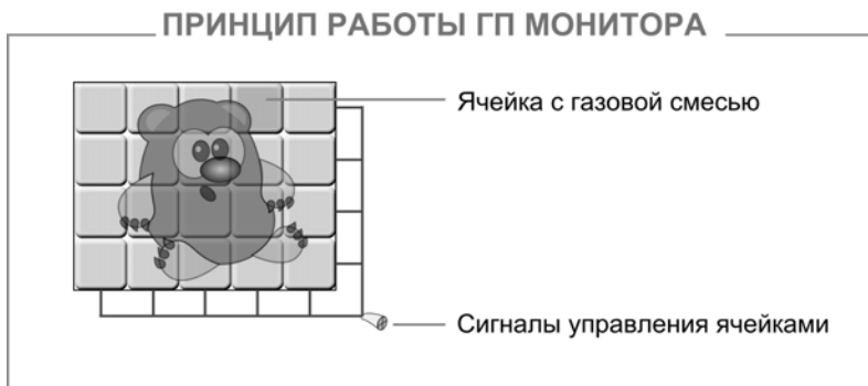
Рис. 2.9. Принцип работы газоплазменного монитора
