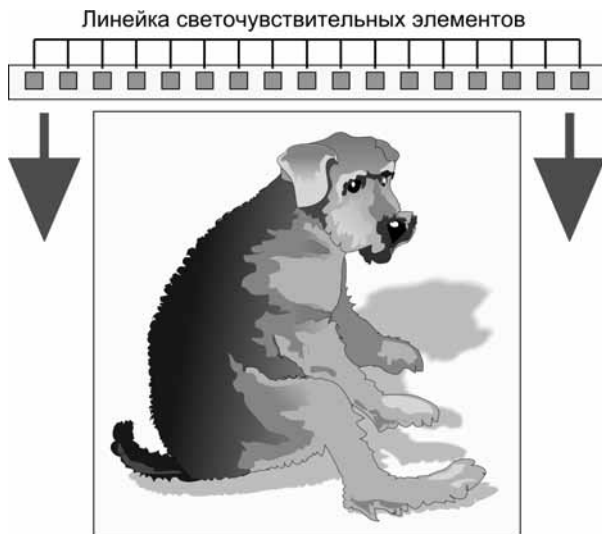
Рис. 10.17. Линейка светочувствительных элементов сканера
