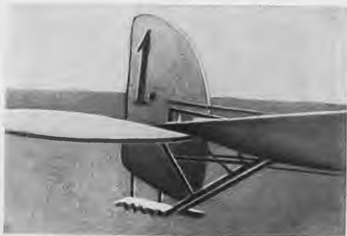
Пилообразный нож для пропарывания оболочек аэростатов, установленный под хвостовой частью самолета Нестерова.
